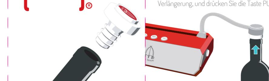
A Appliquez le bouchon (avec valve) à la bouteille, raccordez la rallonge au bouchon et appuyez sur la touche PUMP
